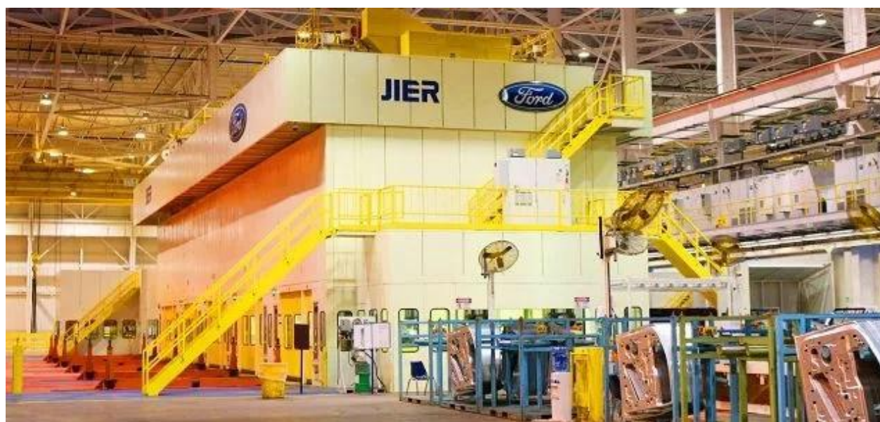
(济南二机床为福特工厂提供的大型冲压生产线)
